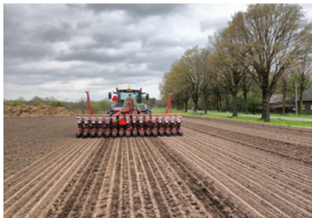
Een precisiezaaimachine kan zorgen voor een lichte besparing op zaaizaad, omdat de verdeling van het zaaizaad in de rij heel nauwkeurig is.
