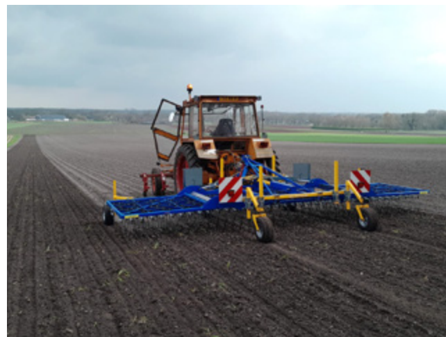
Goed eggen, bij voorkeur met een veerbelaste tandeneg, is vooral in een jong stadium een kwestie van een goede afstelling van de eg in combinatie met de juiste rijnsnelheid.
