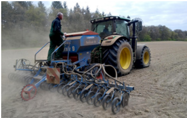
Pneumatische zaaimachine met schijfkouters die ervoor zorgen dat het zaad mooi op diepte kan worden weggelegd.
