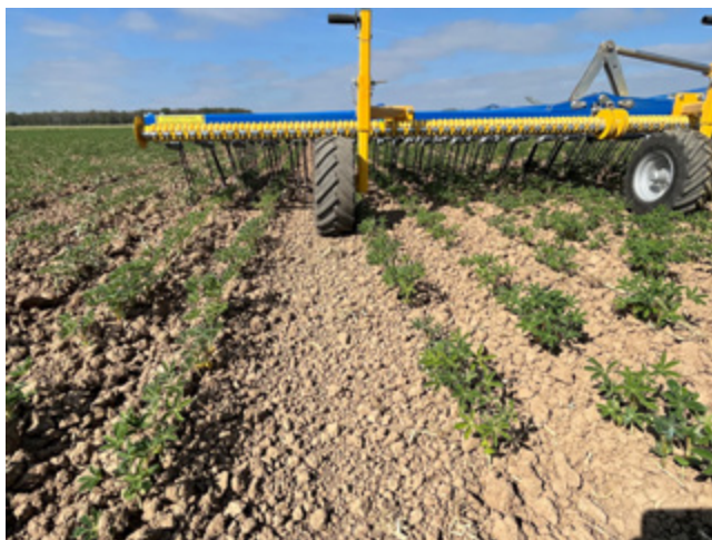
De techniek van het eggen heeft de laatste jaren enorme vooruitgang geboekt met veerbelaste tandeneggen die heel nauwkeurig afgesteld kunnen worden.
