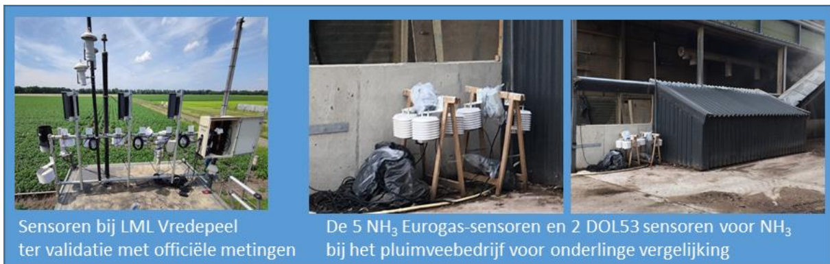
Figuur 11 Foto links: sensoren bij het meetstation van het RIVM in Vredepeel Foto midden en rechts: experiment met NH 3 sensoren in de buitenlucht - opstelling bij de stal
