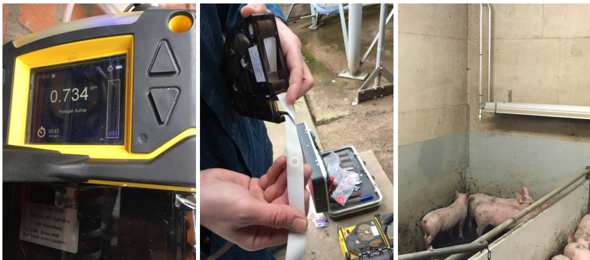
Figuur 12 Sensor voor H 2 S, links de display van de sensor, midden stukje tape dat wordt gebruikt voor de meting en rechts de aanvoer van lucht uit de afdeling boven de biggen
