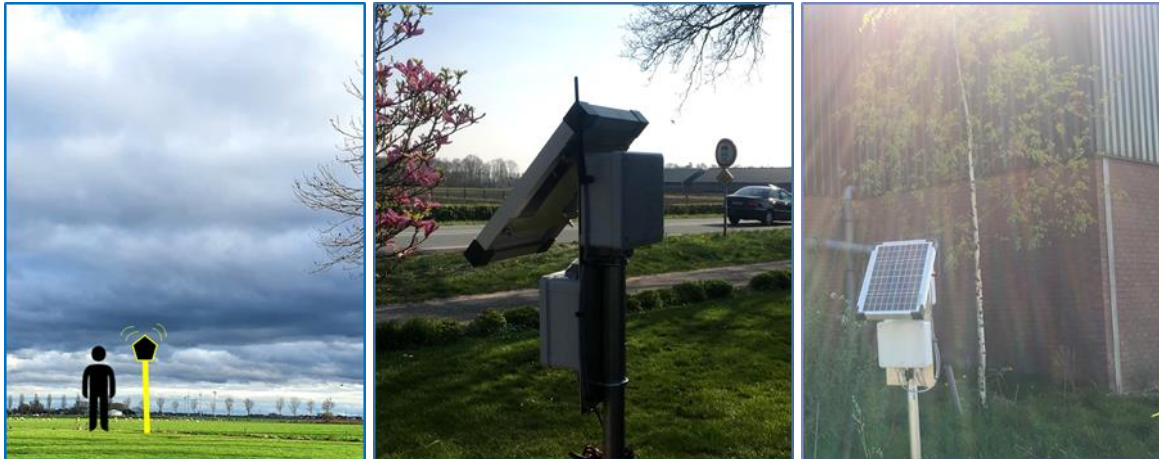
Figuur 10 De sensoren zijn geplaatst op 1,5 tot 2 meter hoogte (“neushoogte”), lucht is altijd in beweging wat met de kleurovergangen is geïllustreerd. De twee foto’s zijn de sensoren in het meetnetwerk
