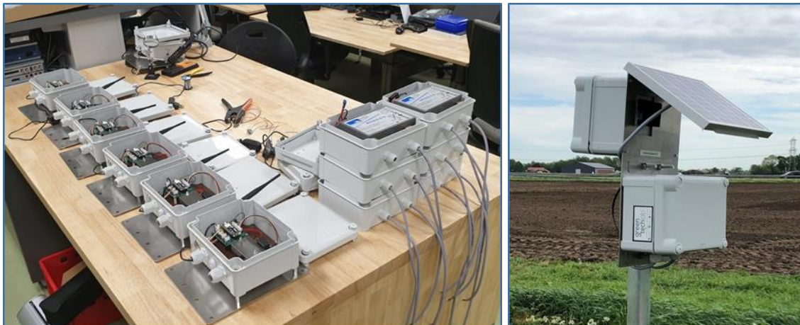
Figuur 7 De assemblage van de sensorkits en een fijnstofsensoren met zonnepaneel in het veld
