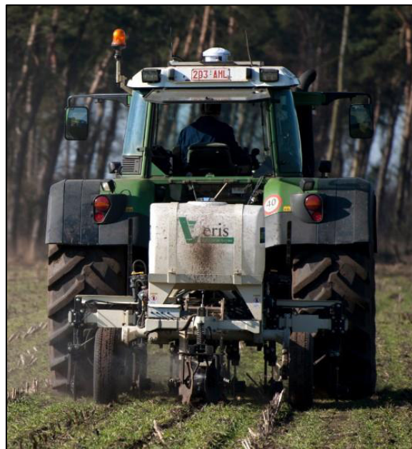
Figuur 1: De Veris bodemscanner in de hefinrichting van de tractor
