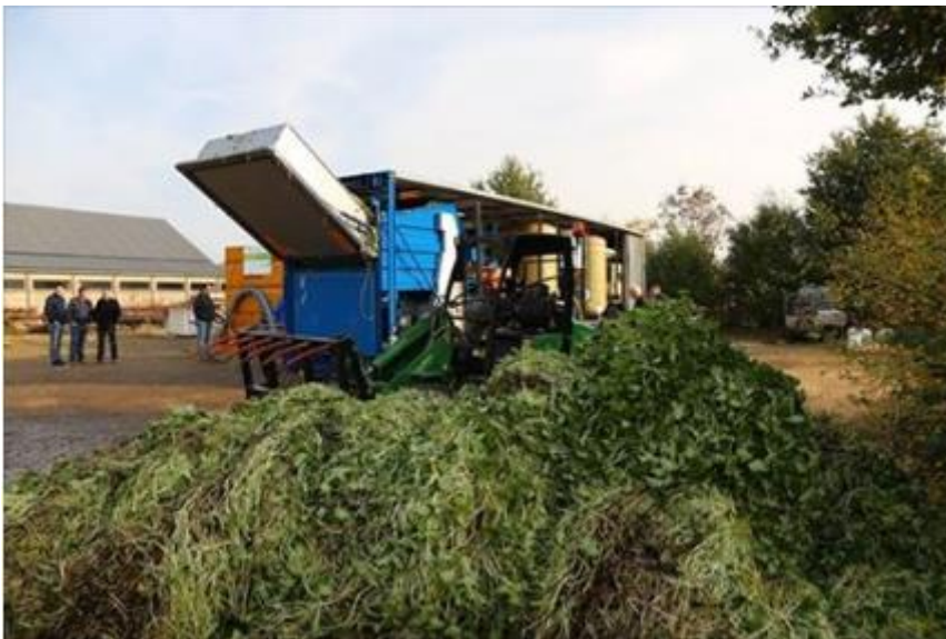
Figuur 2.2. De mobiele raffinage installatie van Grassa die Grote Waternavel verwerkt in een sapfractie (met eiwitten en fosfaten) en een vezelfractie (voor biocomposieten) (Facebook-pagina Waterschap Aa en Maas, 24 november 2016)
