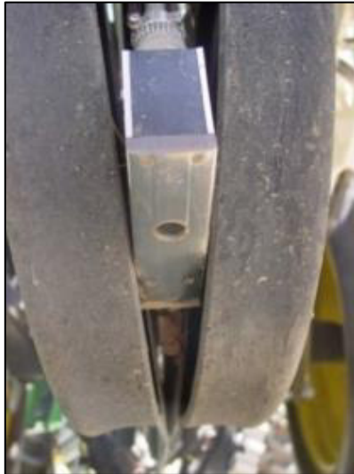
Figuur 7: Optische sensor tussen 2 schijven
