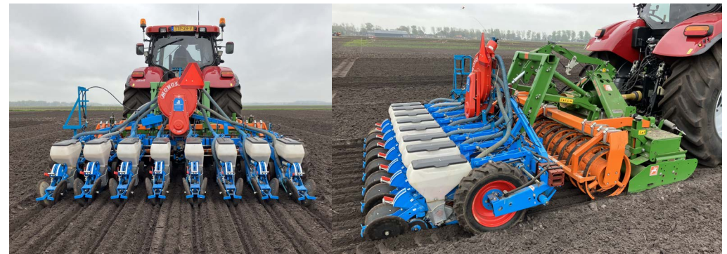
Foto 8.1 Precisiezaaimachine met rotorkoep als voorbereiding (rijenafstand 37,5 cm). Foto's WUR.
